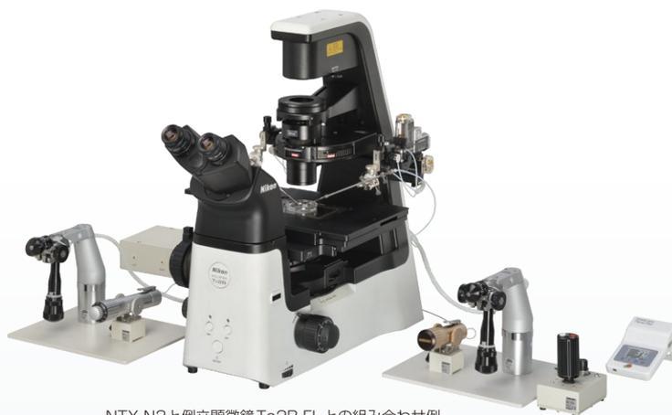
NTX-N3と倒立顕微鏡 Ts2R-FLとの組み合わせ例
