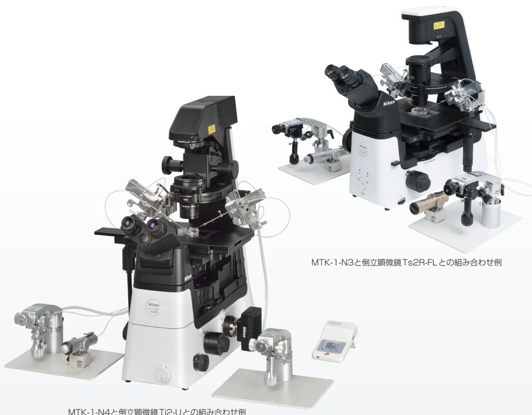
MTK-1-N4と倒立顕微鏡Ti2-Uとの組み合わせ例
